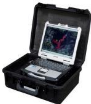
Наземная станция управления в кейсе пыле- влагозащищенного исполнения
