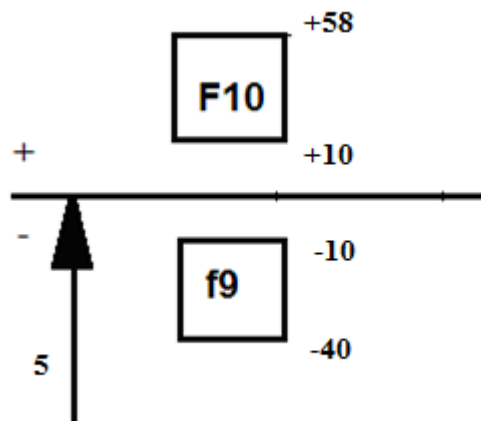
Рис. 5.3 - Схема полей допусков шлицевого соединения
