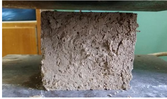
Рис. 19. Испытание образцов на сжатие
