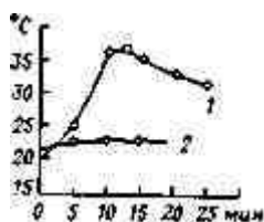
Рис. 10.1. Повышение температуры порошков магния (1) и алюминия (2) при добавлении к ним воды
