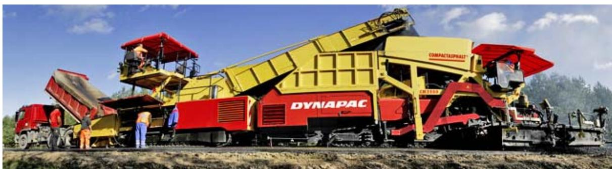
*Рис. 1.1. Асфальтоукладочный комплекс для одновременной укладки двух слоев асфальтобетонного покрытия по технологии «компакт-асфальт»*
