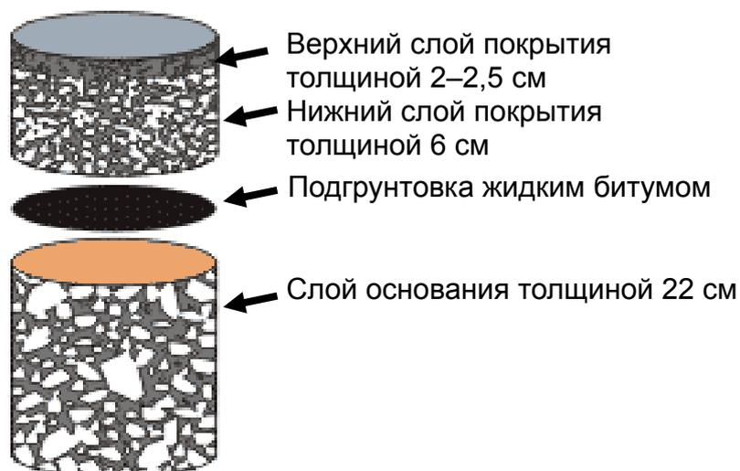
Рис. 1.3. Конструкция покрытия из «компакт-асфальта»
