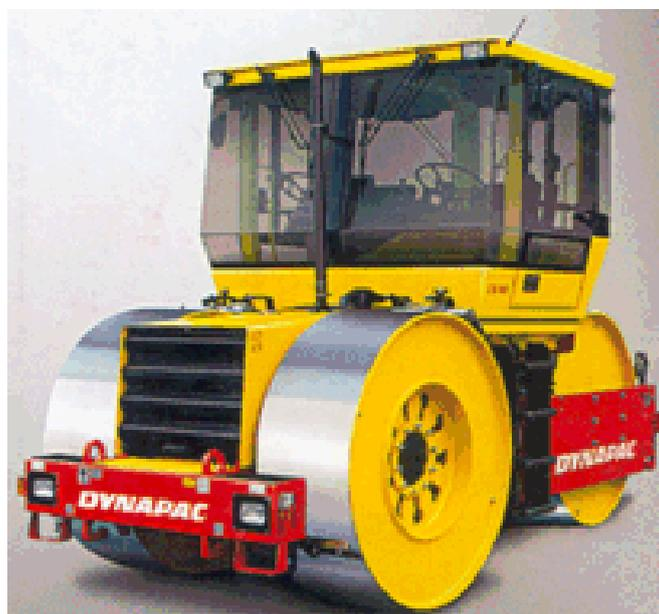
*Рис. 5.5. Трехвальцовый каток статического типа CS 141/142*
