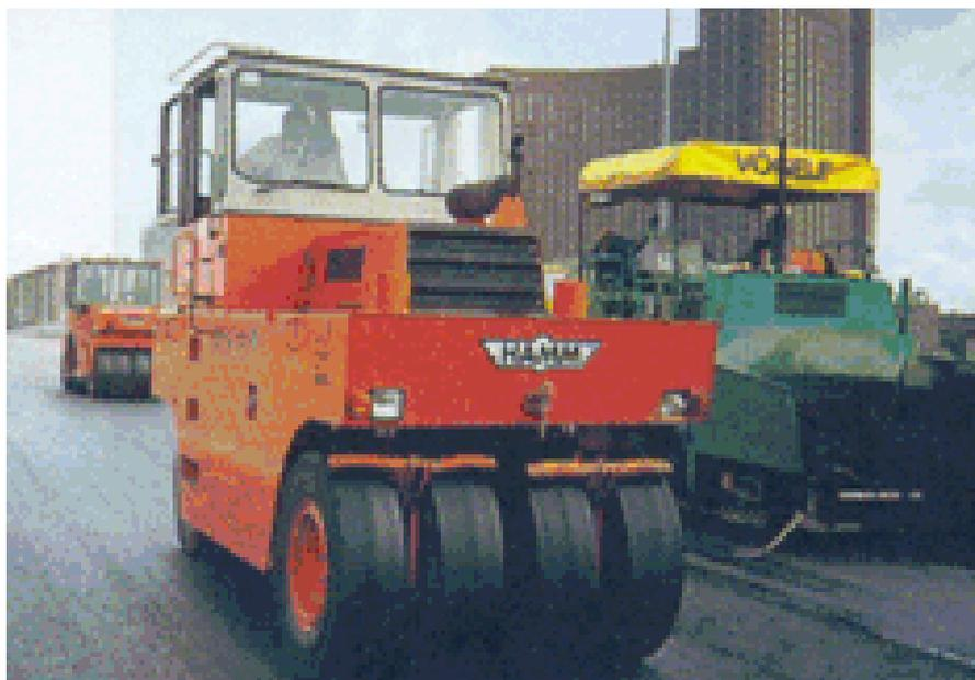
Рис. 5.4. Каток на пневмошинах GRW 15
