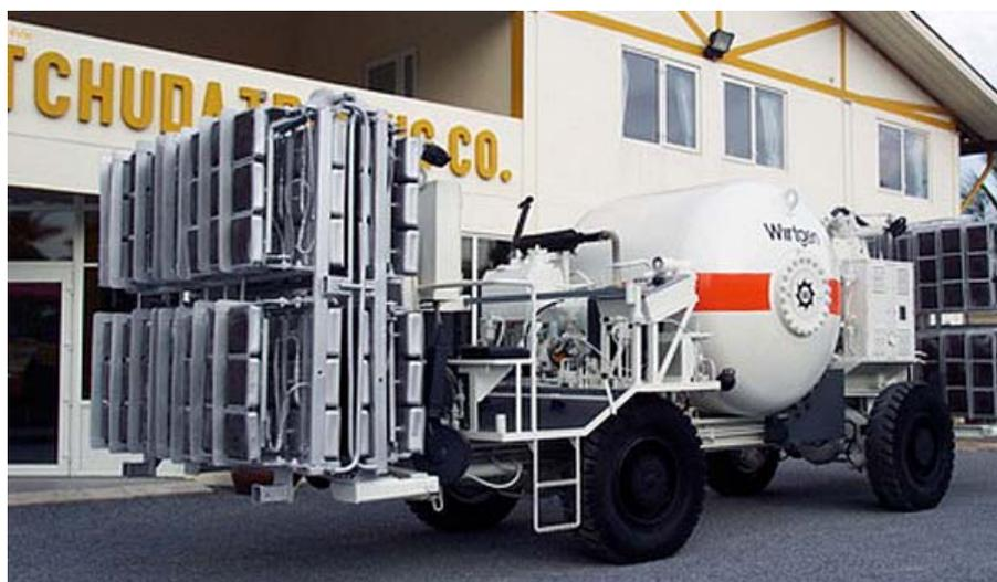
Рис. 3.2. Терморазогреватель дорожного покрытия с газовыми горелками инфракрасного излучения
