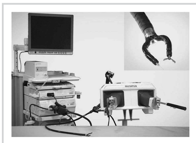
Рис. 4. Система EndoSamurai для управления инструментами с несколькими степенями свободы.
