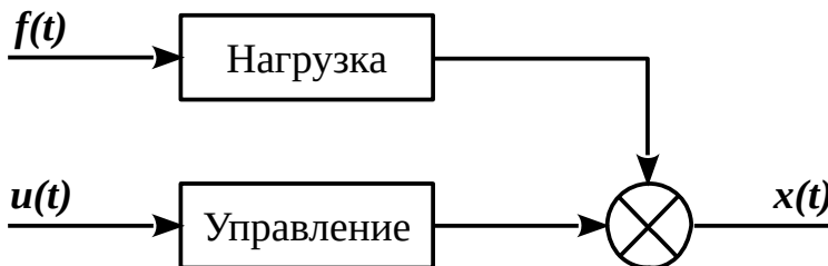
Рис. 37. Эквивалентная схема электродвигателя с технологической нагрузкой
