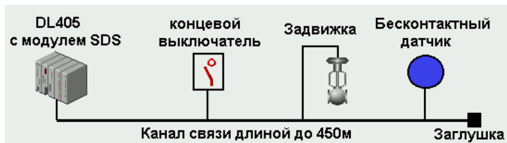
Рис. 2.5.7. Распределенный ввод/вывод на базе шины SDS.
