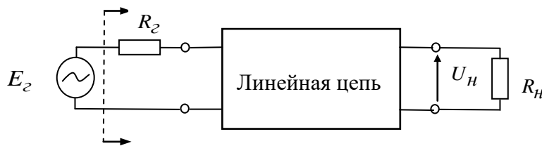
Рисунок 8.3 – К определению входной и передаточной функций линейной цепи с постоянными параметрами
