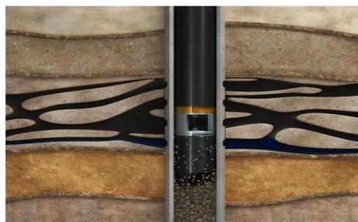
г) Сжатие и охлаждение плазмы приводит к выносу закупоривающих осадков в ствол скважины, а ударная волна переходит в объемную упругую волну
