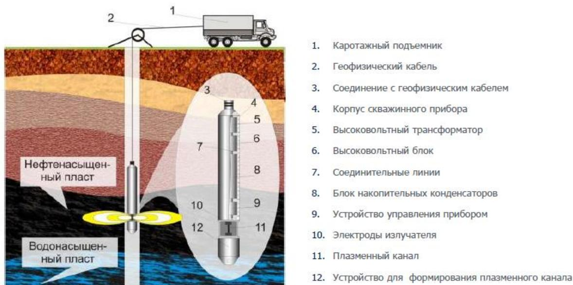
Рисунок 2.3. – Используемое оборудование при спуске и состав прибора
