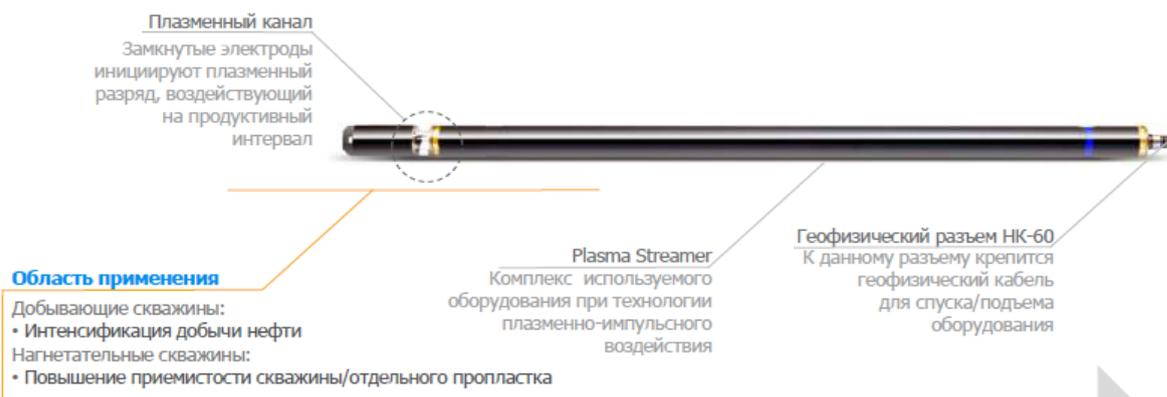
На рисунке 2.4. приведен принцип расположения оборудования при спуске прибора в скважину, а также состав самого прибора.
