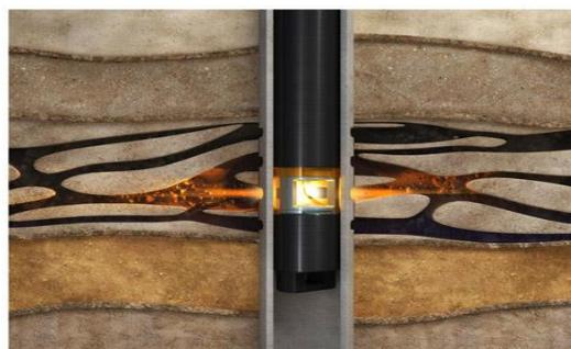
в) Расширяющаяся плазма создает ударную волну, которая через перфорационные каналы проникает в призабойную зону и далее в пласт
