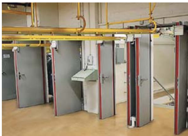
Рис. 8. Общий вид беззорной системы для подвесных конвейеров
