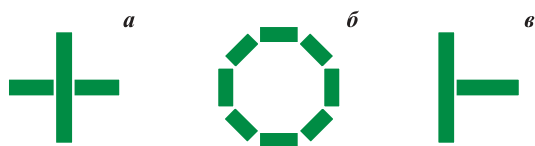
Рис. 4. Варианты расположения противопожарных штор с крестообразным (а), полигональным (б) и Т-образным (в) стыком полотен
