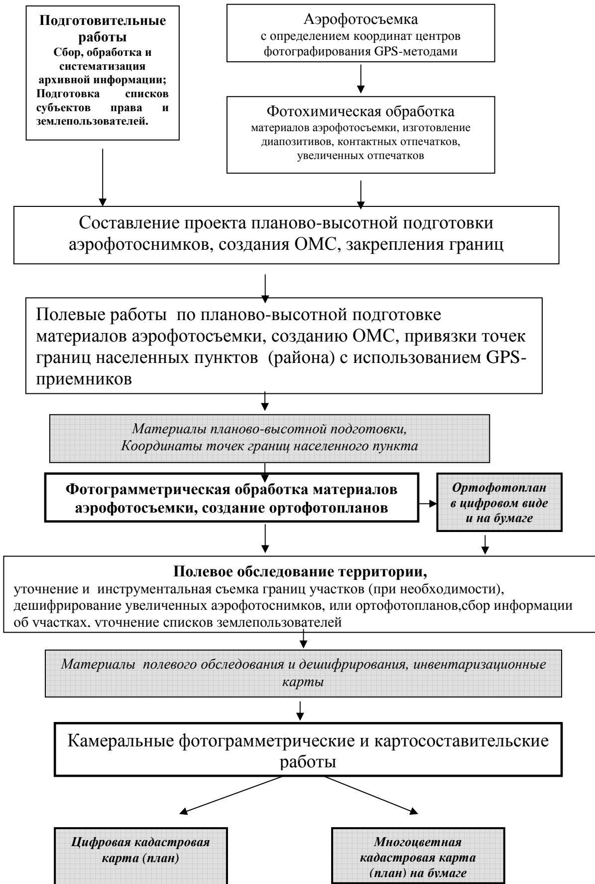
Рис.8.1.1. Технологическая схема производства работ по созданию кадастровых карт и планов с полевым дешифрированием на ортофотопланах
