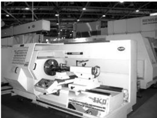
Рис. 3.8. Общий вид токарного многофункционального станка с ЧПУ мод. САТ630С10Ф3.
