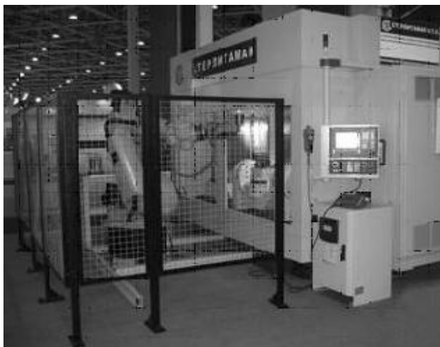
Рис. 3.7. Общий вид гибкого производственного модуля мод. СА630М01
