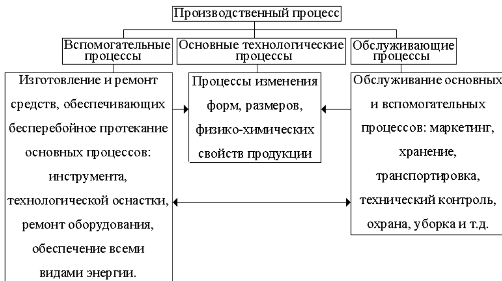
Рис. 1.3.. Структура производственных процессов
