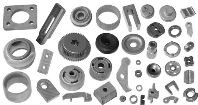
Рис. 5.10. Примеры деталей, изготовленных из КПМ.
