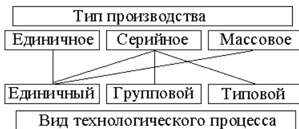
Рис. 3.2. Применяемость технологических процессов в различных типах производства.
