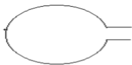
Рис. 2.1. Возможная реализация абсолютно чёрного тела.
