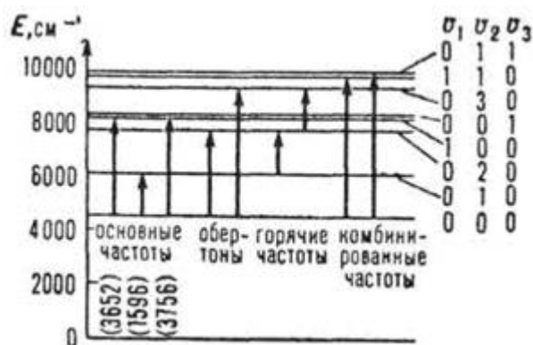
Система колебательных термов E/hc (см -1 ; c - скорость света) молекулы H 2 O и некоторые переходы; v_1, v_2, v_3 - колебательные квантовые числа.
