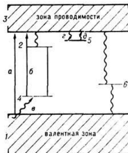
Рис. 3. Схема переходов при люминесценции кристаллофосфоров: 1 - валентная зона; 2 и 4 - уровни центра люминесценции; 3 - зона проводимости; 5 - ловушки электронов; 6 - уровень безызлучательной рекомбинации. Переходы а и б соответствуют возбуждению люминесценции, в - ионизация центра дыркой, г и д - оседание электронов на ловушках и их освобождение.
