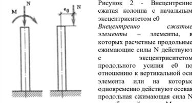
Рис. 5.9. Рисунок 2 — Внецентренно сжатая колонна с начальным эксцентриситетом е0
