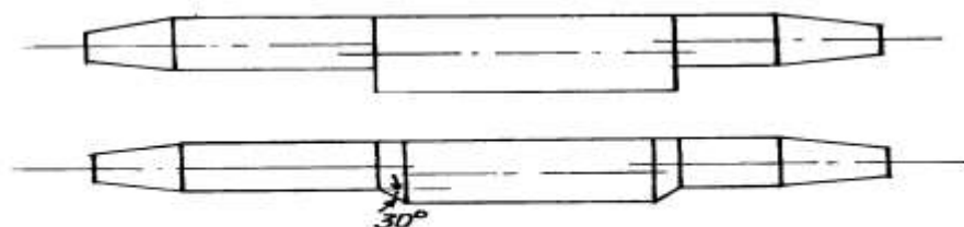
Рис.6.5 Корпус из обечаяек разного диаметра
