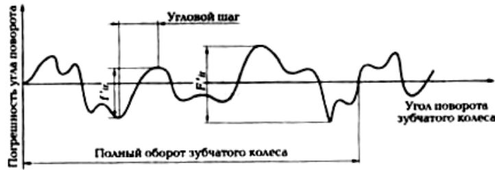
Рис. 4.39. График изменения кинематической погрешности
