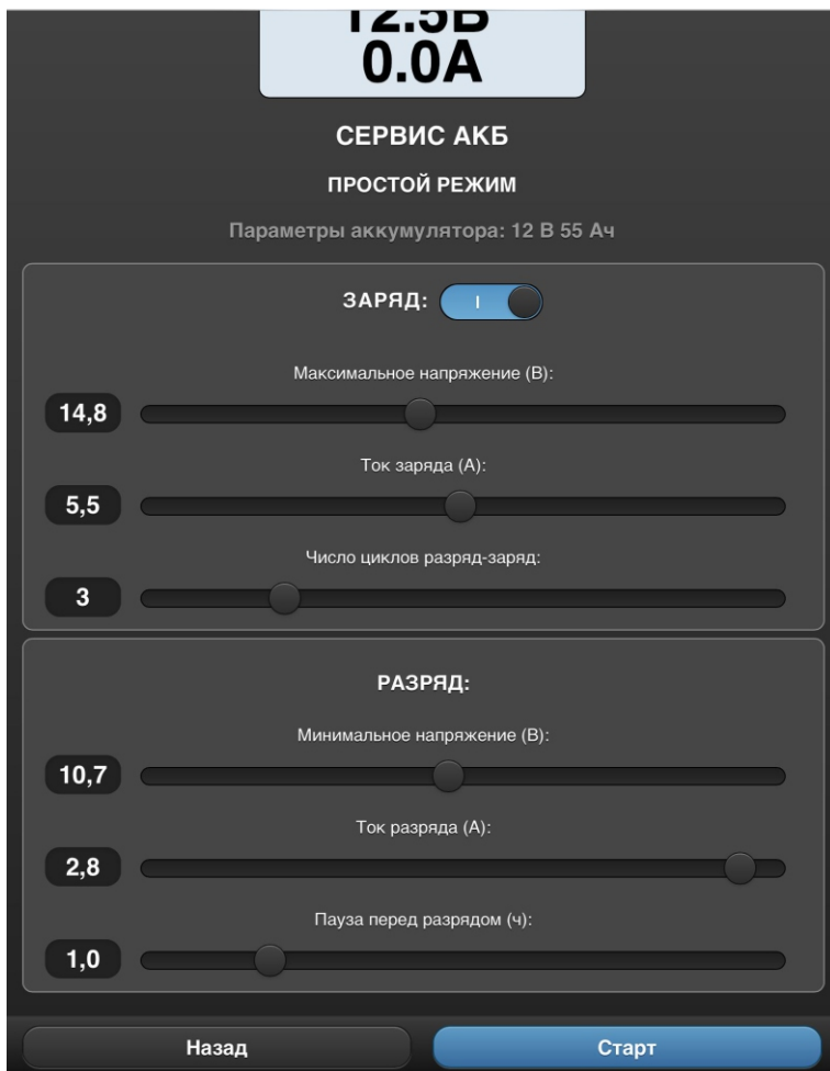
Рис. 18 - Установка параметров заряда и разряда
