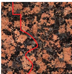
Рис. 9.1. Модель развития магистральной трещины в граните
