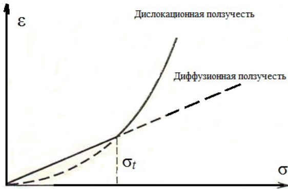
Рис. 8.7. Графики зависимости для дислокационной и диффузионной ползучести
