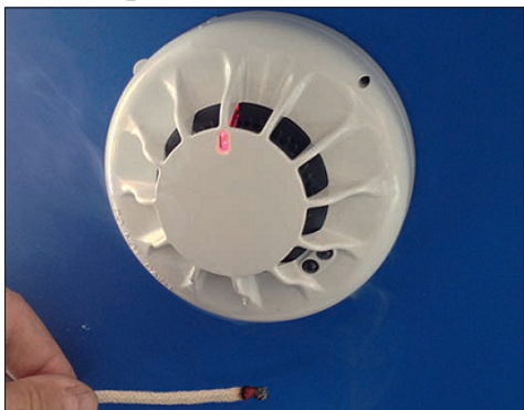
Рис. 2. Воздействие тлеющего фитиля соответствует максимальному уровню задымления и концентрации угарного газа СО
