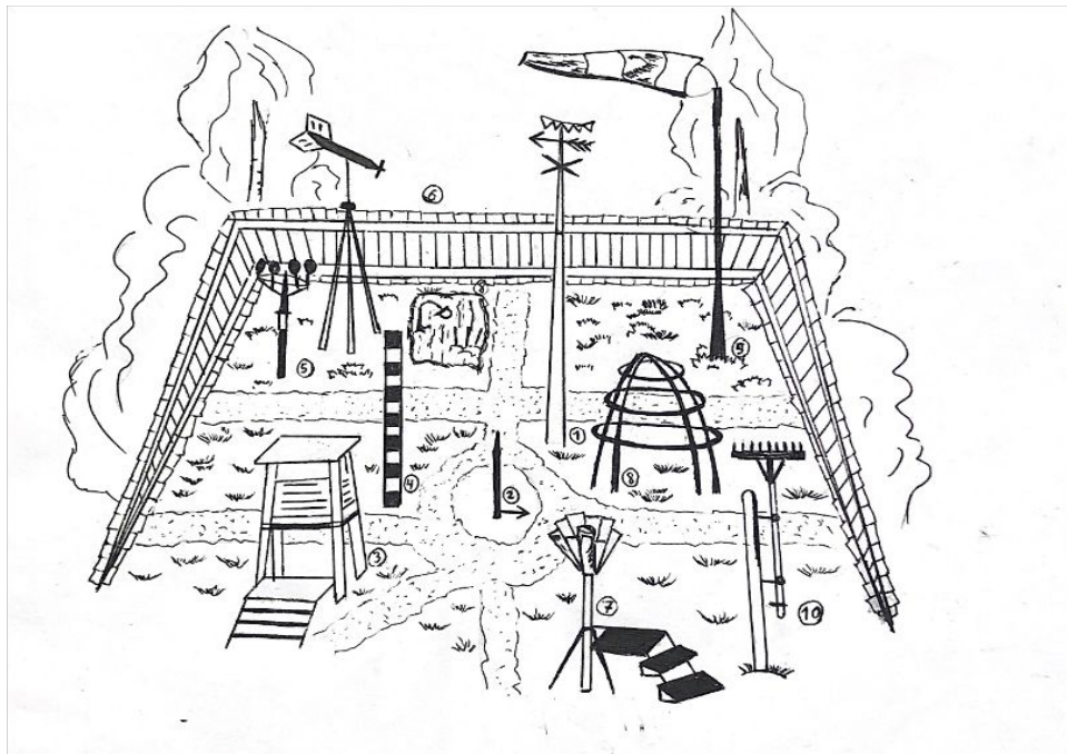
Рис.8 Схематический план размещения оборудования на метеорологической площадке.
