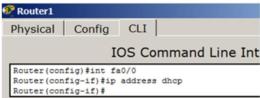
**Рис. 6.24.** Конфигурируем интерфейс маршрутизатора
