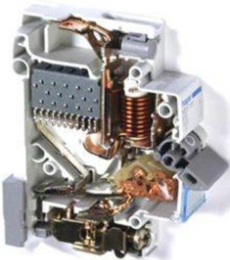
Согласно этим опытам можно считать, что при наличии магнитного поля гашения дуги при напряжении до 500 В можно принять значение раствора 10 — 12 мм для постоянного тока, для переменного тока принимают 6 — 7 мм для любых значений тока. Излишнее увеличение раствора нежелательно, так как оно ведет к увеличению хода контактных частей аппарата, а следовательно, к увеличению габаритов аппарата.
