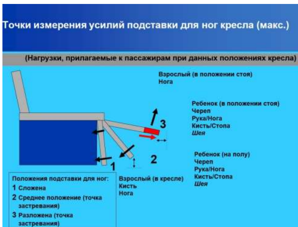
Рисунок 6 - Точки измерения подставки для ног для движущихся частей
