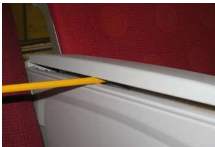
Рисунок Б2 – Крышка подлокотника кресла со встроенным столиком. Это пример элемента с оценкой 1А по классификации таблицы Анализа потенциальной вероятности травмы
