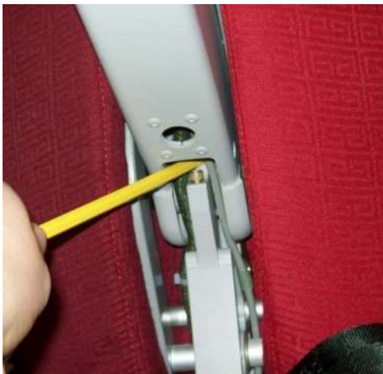
Рисунок Б6 - Шарнирная точка убирающегося подлокотника кресла. Это пример элемента с оценкой 2В по классификации таблицы Анализа потенциальной вероятности травмы
