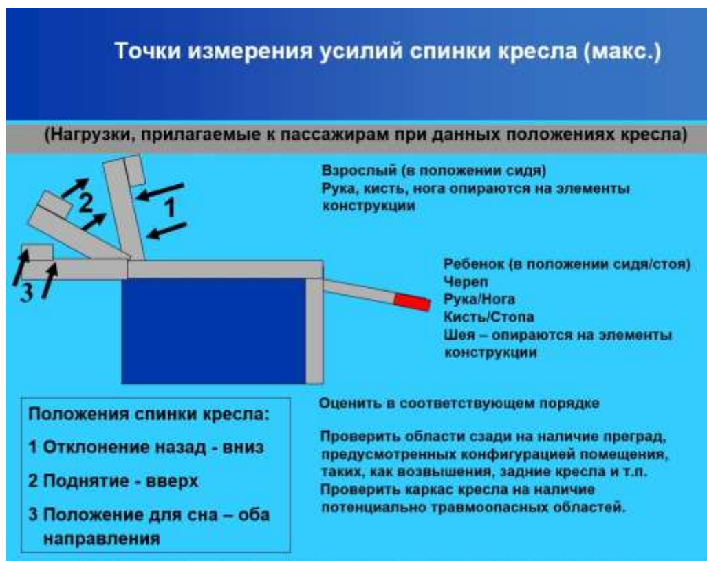
Рисунок 8 – Точки измерения спинки кресла для движущихся частей
