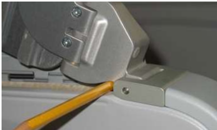
Рисунок Б3 – Шарнир столика, встроенного в подлокотник кресла. Это пример элемента с оценкой 1А по классификации таблицы Анализа потенциальной вероятности травмы
