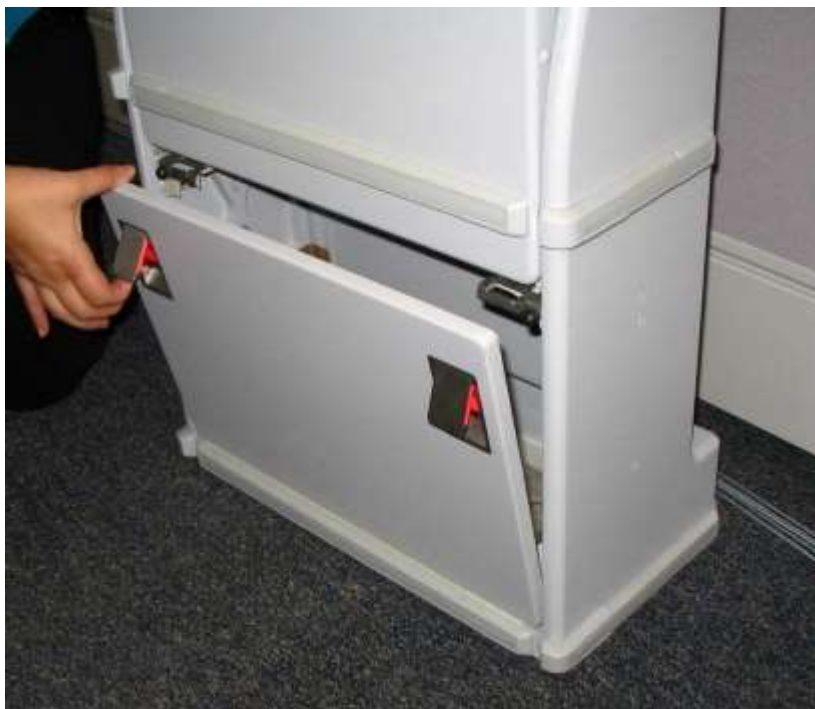
Рисунок Б4 – Дверца укладочного ящика на пружине. Это пример элемента с оценкой 4А по классификации таблицы Анализа потенциальной вероятности травмы, на основании потенциала силы пружины
