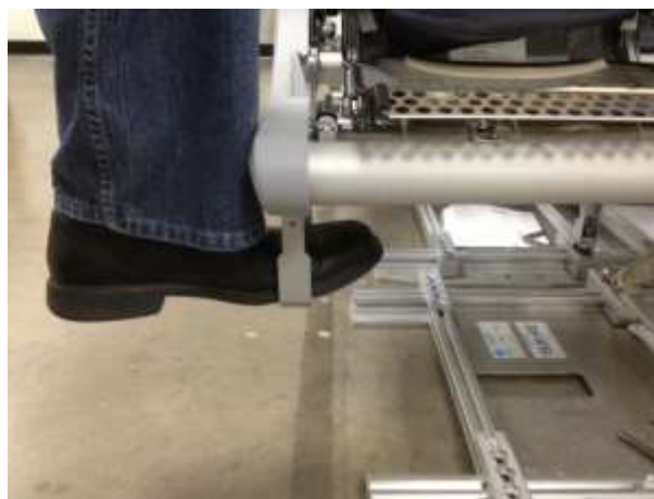
Рисунок 18 – Пример петли-ступеньки в виде стремени, конструкция которой обеспечивает приемлемое расположение ноги
