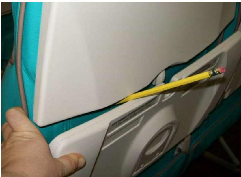
Рисунок Б5 – Откидной столик, расположенный на спинке кресла. Это пример элемента с оценкой 1А по классификации таблицы Анализа потенциальной вероятности травмы
