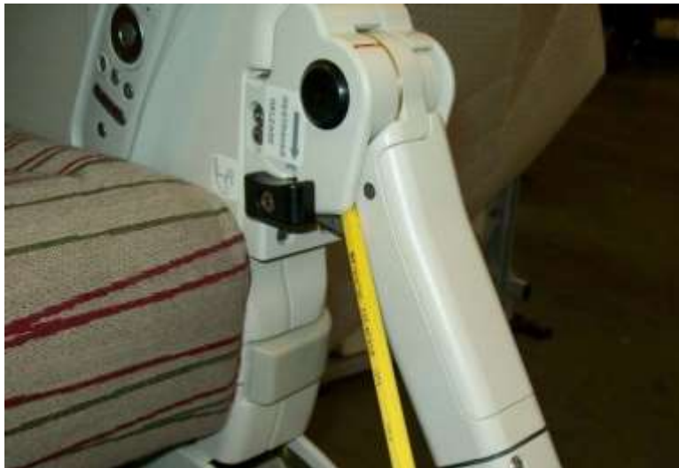
Рисунок Б1 – Шарнир встроенного в подлокотник кресла видеомонитора. Это пример элемента с оценкой 1А по классификации таблицы Анализа потенциальной вероятности травмы.
