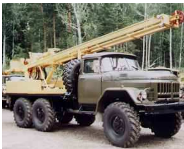
Рисунок 12.1 – Буровая установка УРБ 2А2 на шасси Амур 531300 (ЗИЛ-131)
