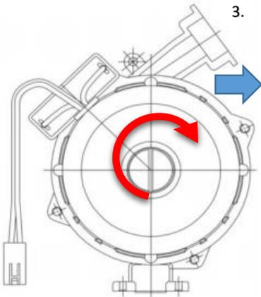
3. Отключите электропитание котла. Проверьте правильное расположения DIP-switch и выставите значения DIP-switch 10;11;12 в положение согласно таблицы «установка мощности котла» для настройки мощности.
