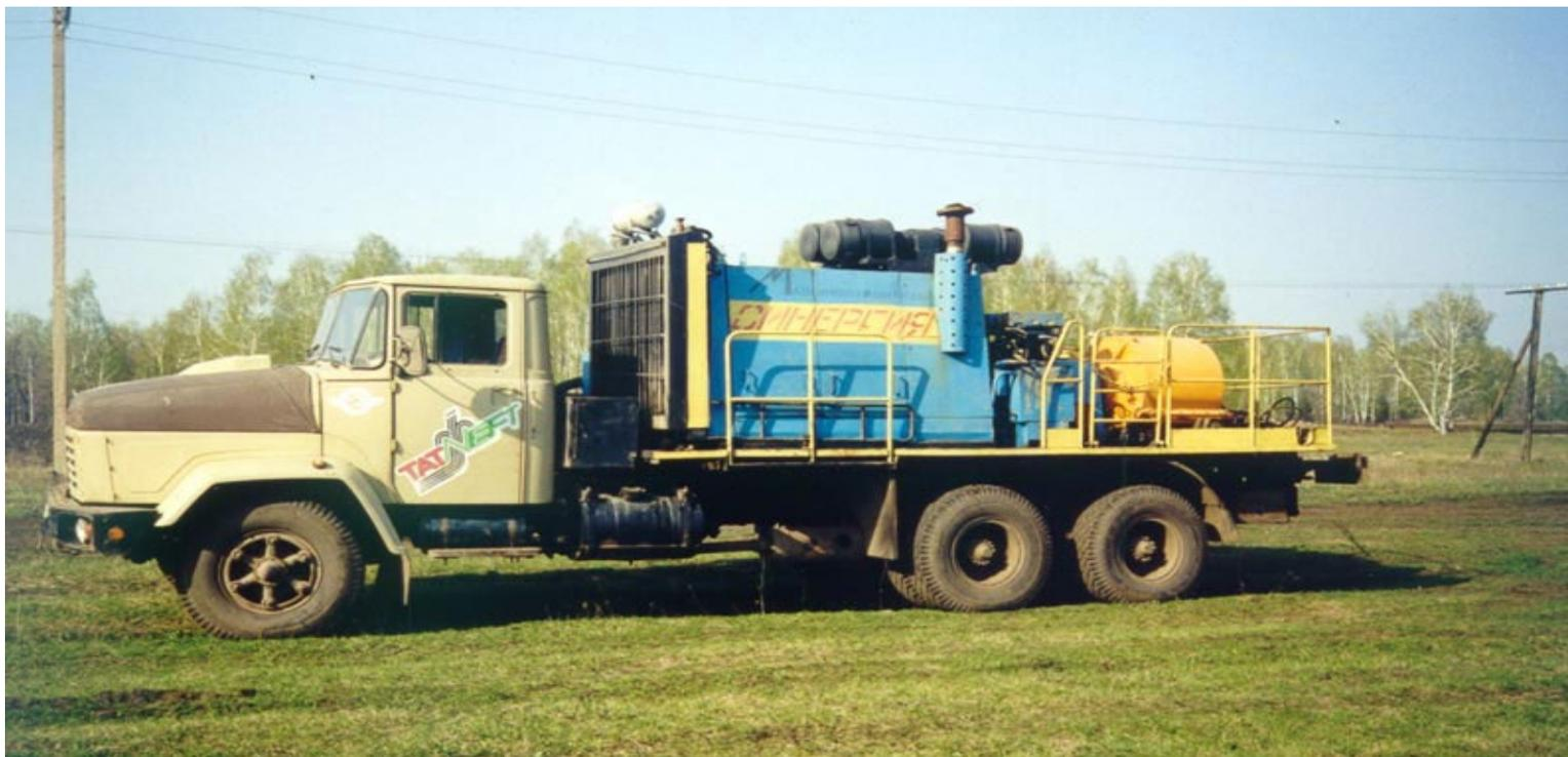
**Тип насоса** – трехплунжерный горизонтальный одностороннего действия
