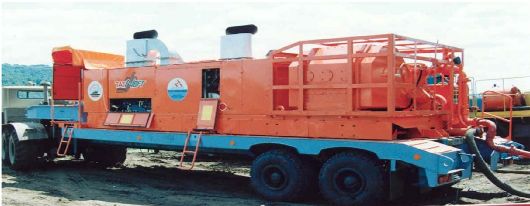
**Тип насоса – трехплунжерный горизонтальный одностороннего действия.**
