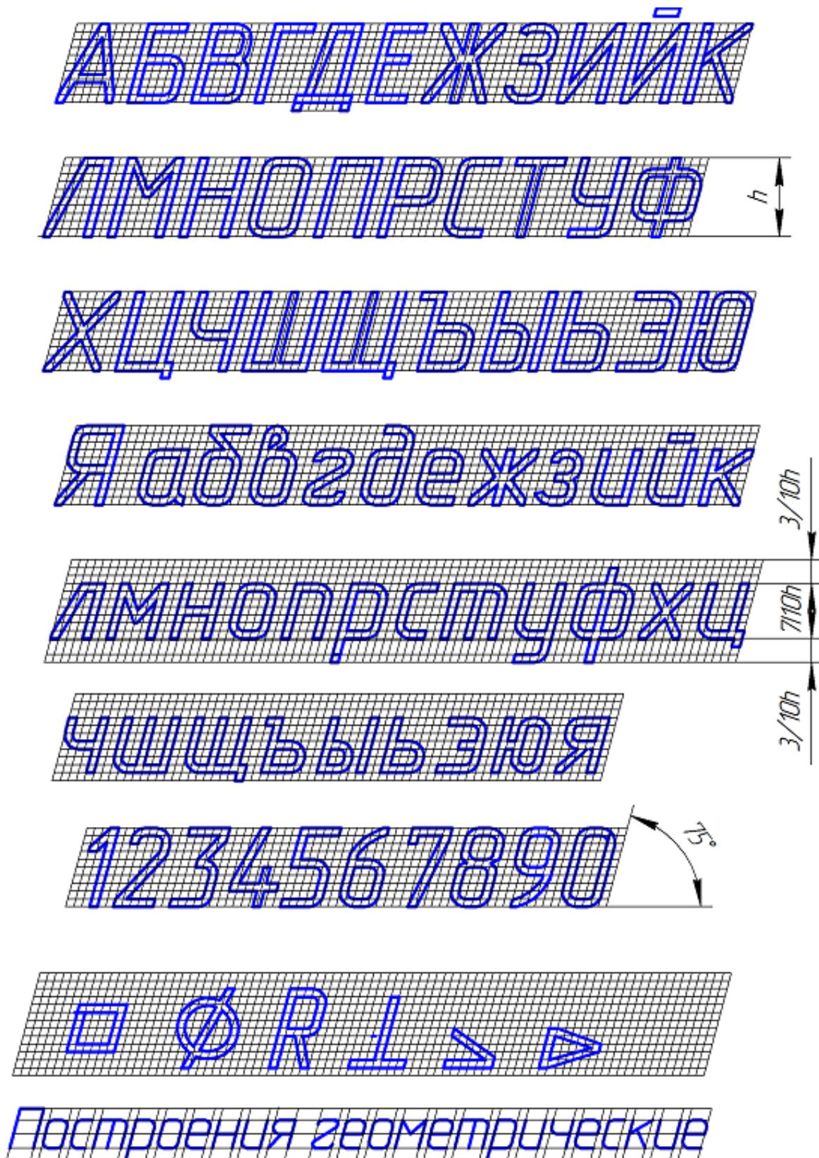
Рисунок 11 - Шрифт типа Б с наклоном
