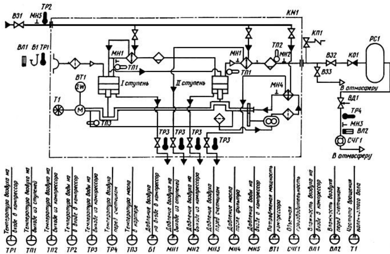
*B1* - барометр; *BT1* - ваттметр; *ВЛ1, ВЛ2* - влагомеры; *ВД1* - дросселирующий вентиль;
