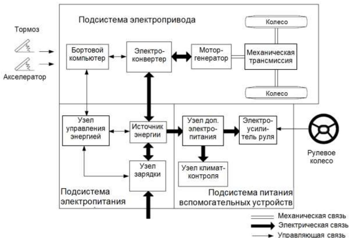
Рис. 40. Концептуальная схема батарейного электромобиля
