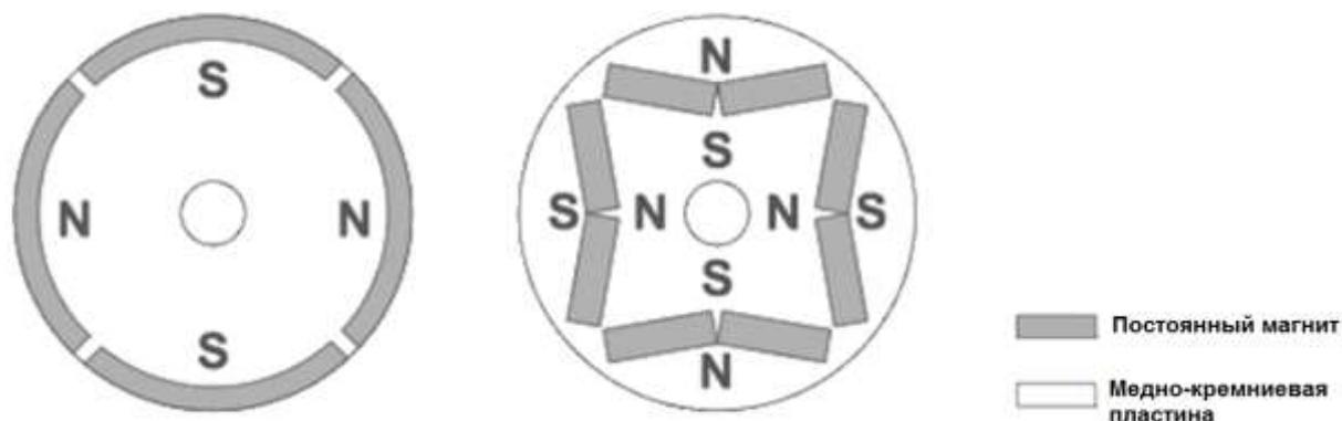
*Рис. 57. Варианты расположения постоянных магнитов в роторе синхронных моторов переменного тока*
