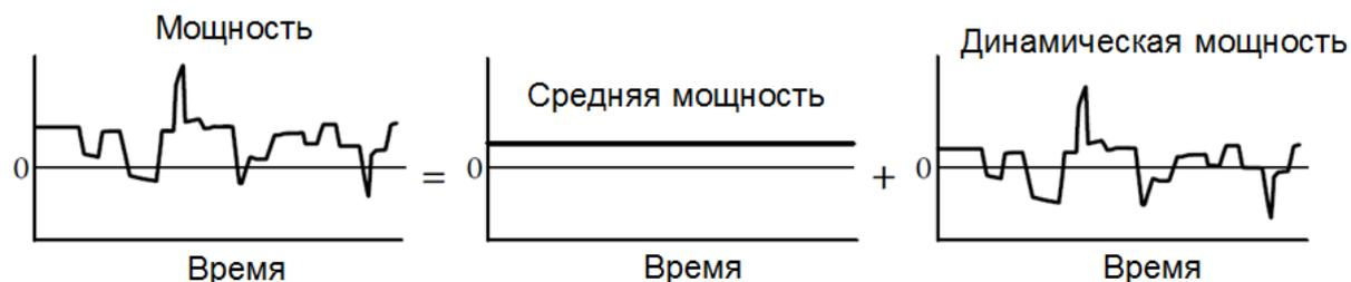
*Рис. 43. Декомпозиция мощности сопротивления движению автомобиля на среднюю и динамическую составляющие*
