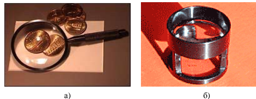
Рис. 6. Лупы для визуального контроля: а – лупа с 4-кратным увеличением (поле зрения 77 мм, размеры 160x80мм, масса 100 г); б – лупа с 10-кратным увеличением с возможностью измерения по измерительной шкале с ценой деления 0,1 мм (поле зрения 35 мм, диаметр 39, высота 36 мм)
