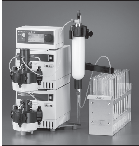
Рис. 38. Хроматограф для препаративной ВЭЖХ
