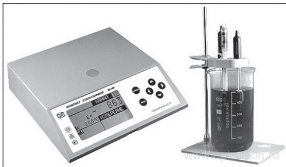
Рис. 16. Микропроцессорный ионмер И-160 предназначен для определения в водных растворах активности ионов водорода (рН), окислительно-восстановительного потенциала (Еh), активности и концентрации ионов: Н + , Li + , Na + , NH 4 + , Ag + , X + , NO 3 - , ClO 4 - , F - , Cl - , Br - , I - , CN - , SCN - , Ca ++ , Ba ++ , Mg ++ , (Ca+Mg) ++ , Pb ++ , Cd ++ , Cu ++ , Hg ++ , X ++ , CO 3 - , S - и др.
