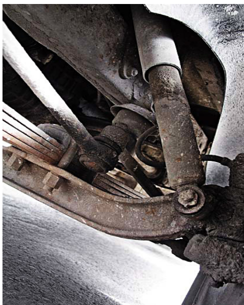
Рис. 4. Элементы подвески а/м «ГАЗель»
