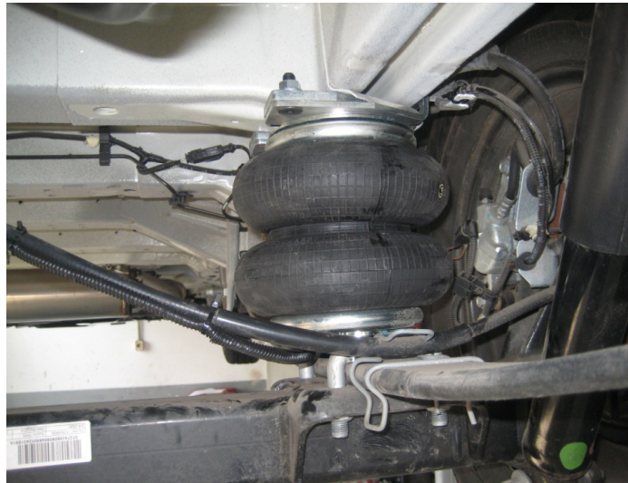
Рис. 5. Установленная пневмоподвеска на автомобиль Peugeot Boxer
