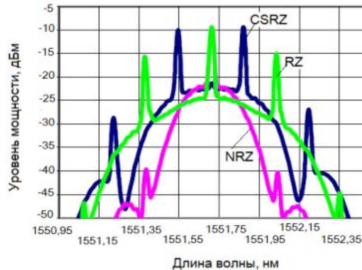
Рис. Спектры сигналов DPSK на выходе модулятора с различными форматами оптических импульсов (NRZ, RZ, CSRZ)
