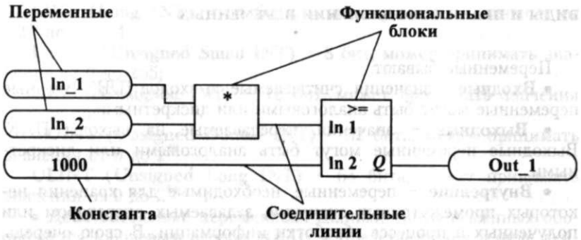
Рис. 15.1. Пример программы на языке FBD
