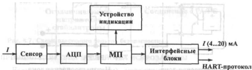
Рис. 8.9. Функциональная схема интеллектуального датчика давления
