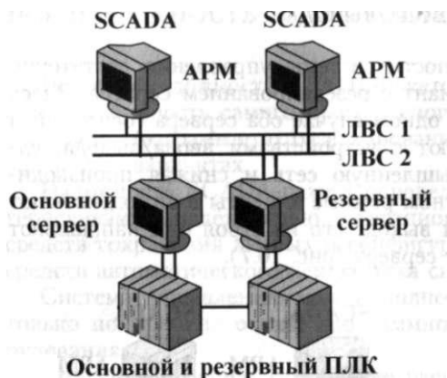
Рис. 16.8. Система с резервированием локальной сети
