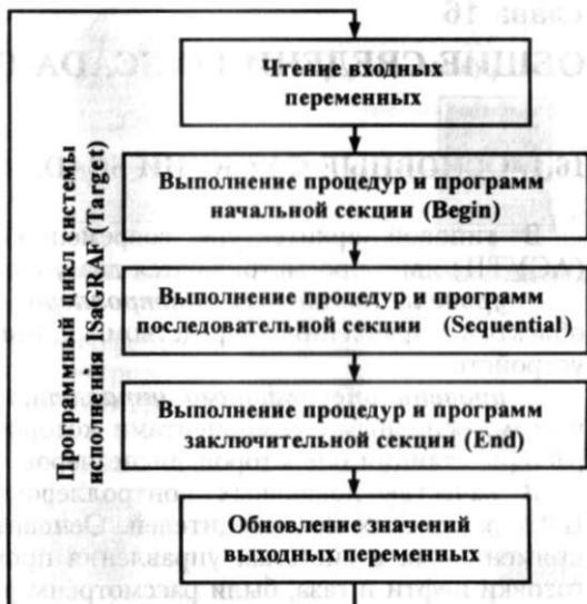
Рис. 15.7. Структура программного цикла в системе исполнения ISaGRAF Target
