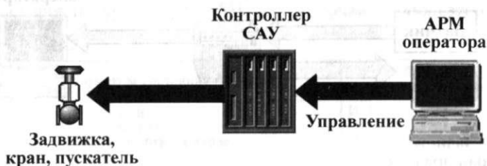
Рис. 19.4. Схема прохождения сигналов при дискретном управлении
