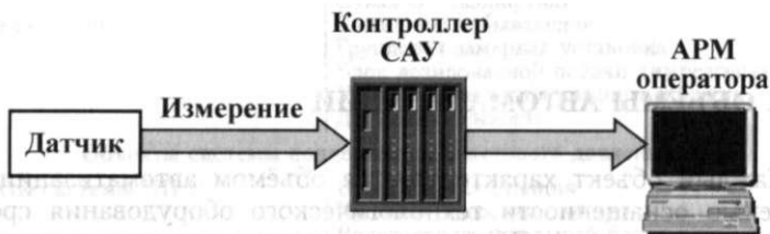
Рис. 19.2. Схема прохождения сигналов в процессе измерения
