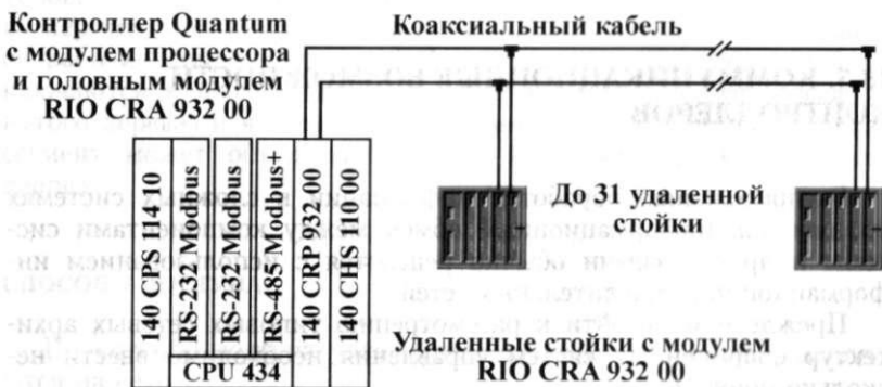
Рис. 13.8. Удаленный ввод/вывод Quantum с резервированием канала связи
