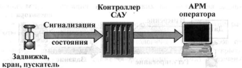
Рис. 19.5. Схема прохождения сигналов при сигнализации состояния
