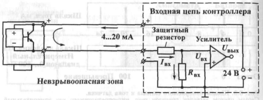
Рис. 8.4. Подключение двухпроводного датчика 4...20 мА к контроллеру с питанием датчиков по входным цепям
