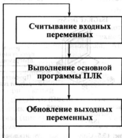
Рис. 15.4. Алгоритм выполнения программы в ПЛК
