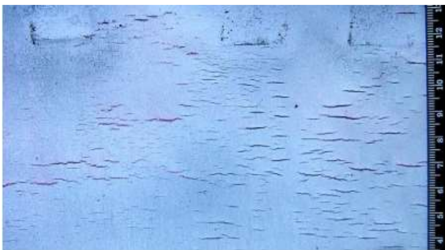
Рисунок 2. Продольные коррозионные трещины в зоне сварного стыка
