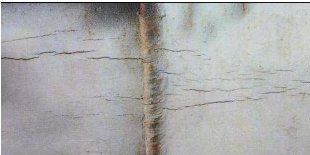
Рисунок 2. Продольные коррозионные трещины в зоне сварного стыка
