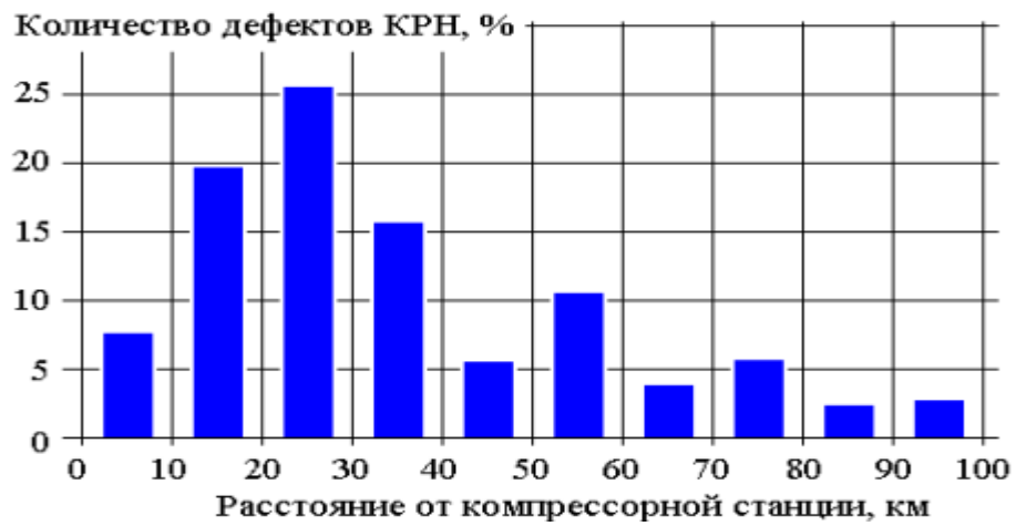
Рисунок 10. Распределение дефектов КРН вдоль газопровода
