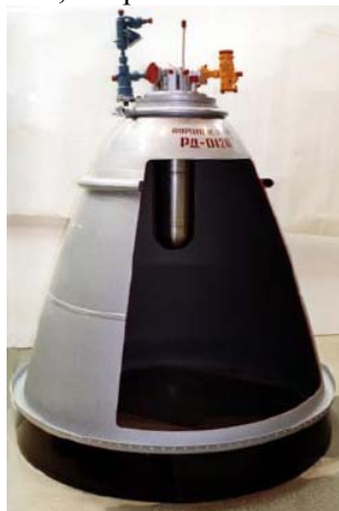
Рис. 6. Камера ЖРД с кольцевым критическим сечением и тарельчатым соплом (макет)
