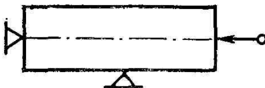
Рис. 9. Базирование призматической заготовки, зажатой в тисках с опорой на плоскость.
