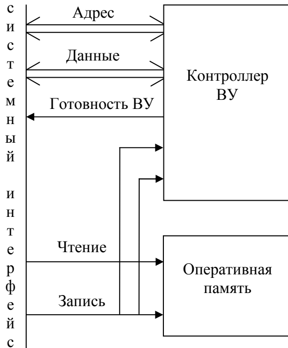
Рис. 38. Простейшее сопряжение контроллера с системным интерфейсом
