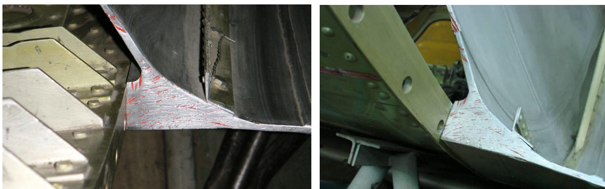
Рис. 2. Конструкция узла стыковки бака с негерметичным отсеком
