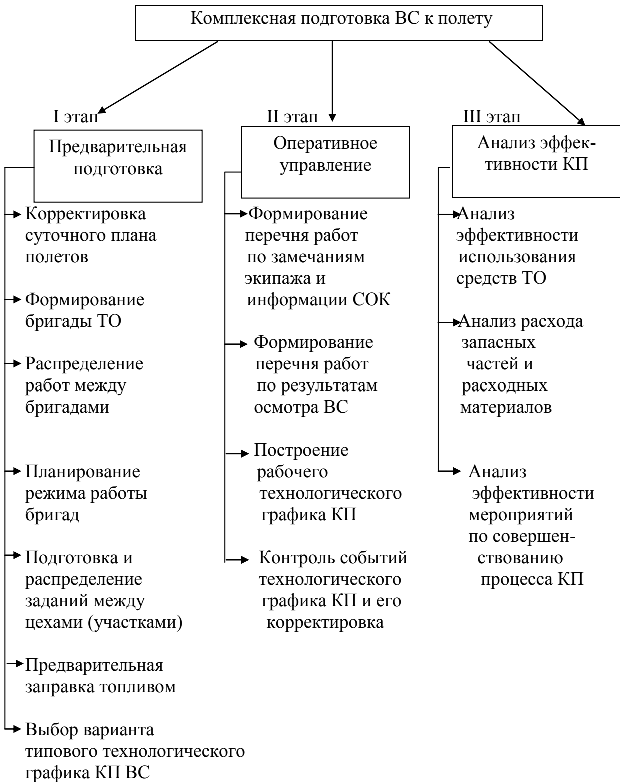
Рис. 3. Содержание задач комплексной подготовки ЛА к полетам, решаемых инженерно-техническим персоналом цеха оперативного ТО
