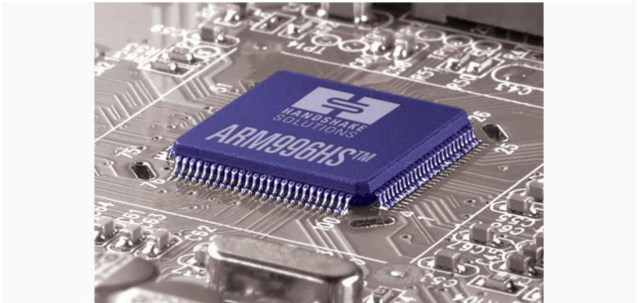
Рис. 2.1. Микропроцессор: транзисторы, резисторы, конденсаторы и соединяющие их проводники в одном кремниевом кристалле
