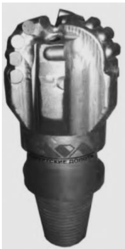
Рисунок 1.36 Долото с алмазно-твердосплавными режцами типа У 123 ST-45 СП ЗАО УДОЛ
