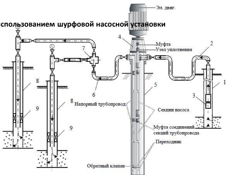
1 - водозаборная скважина; 2 - водовод низкого давления; 3 - электроцентробежный насос (ЭЦН); 4 - насосная установка УЭЦНАКШ; 5 - шурф; 6 - водовод высокого давления; 7 - замерно - распределительный узел; 8 - нагнетательная скважина; 9 - пакер
