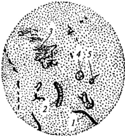
Рис. 2.29. Виды стружек, образующихся при шлифовании:
