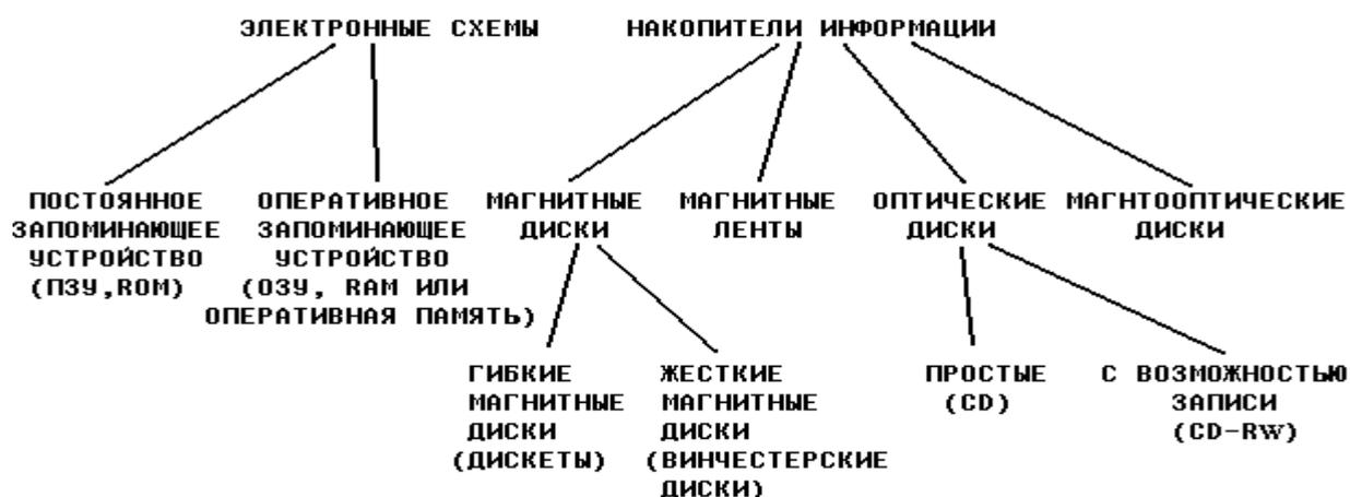
Рисунок 7 – Схема устройства памяти ЭВМ
