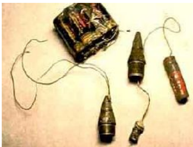
Рис. 2. Электродетонаторы, изготовленные из взрывателей 30-мм осколочно-трассирующих снарядов.
