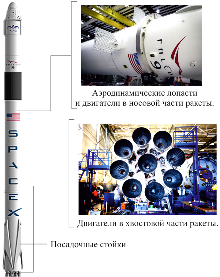
Рис. 4. Способы корректировки траектории ракеты
