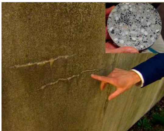
Рисунок 4. Новый стройматериал - самовосстанавливающийся бетон
