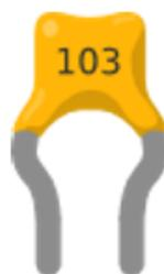
Рисунок 7 - Пример кодировки номинала конденсатора
